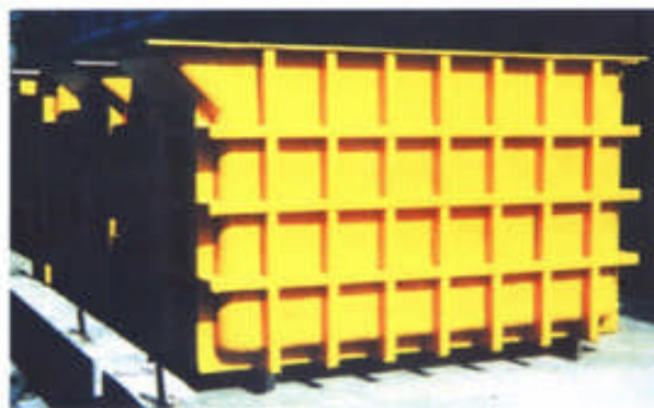
▲湖南郴州冶炼厂使用的玻璃钢电解槽
