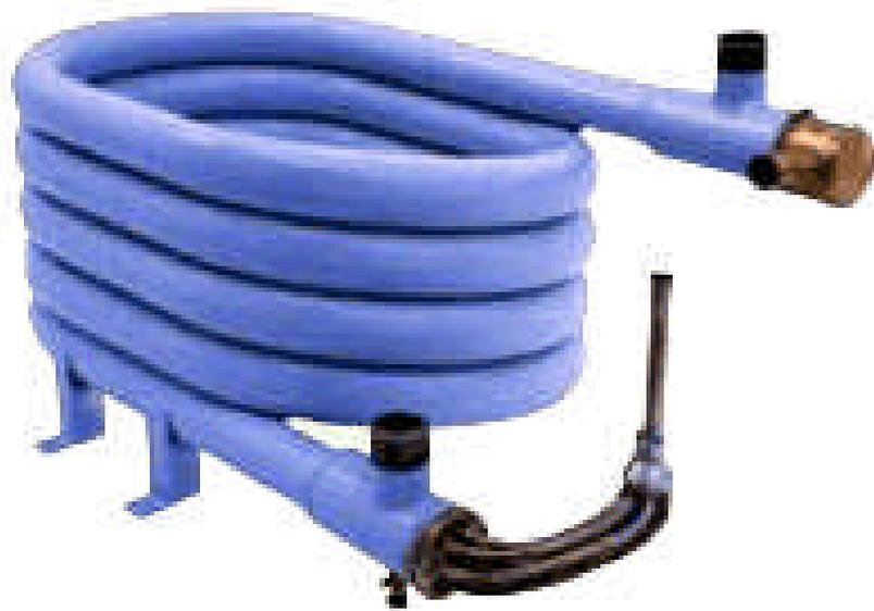
■单管式汽—水换热器，热媒蒸汽在壳程和管程之间由上向下流动，被加热水在管程内由下向上流动。西安建筑科技大学
